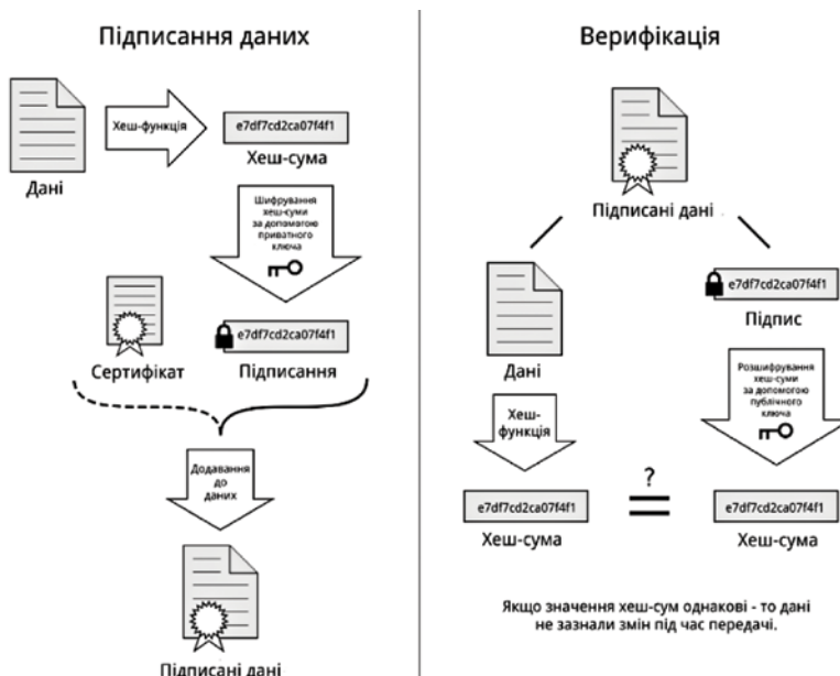
Рис. 1. Алгоритм створення та верифікації цифрового підпису
